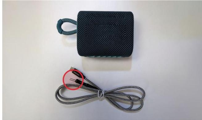
図 7：アンロッカーツールセット。赤で囲まれているのは、車両の CAN バスに接続するためのケーブルの 2 本のピン、CAN ハイと CAN ローです（Ken Tindell のオリジナル画像に基づく）<sup>15</sup>
